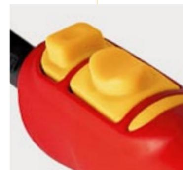
Tlačítka pro ovládání jsou vyrobená z měkké silikonové pryže, vodě odolné (IP 67) a jsou testována na vykonání 5.000.000 cyklů.
